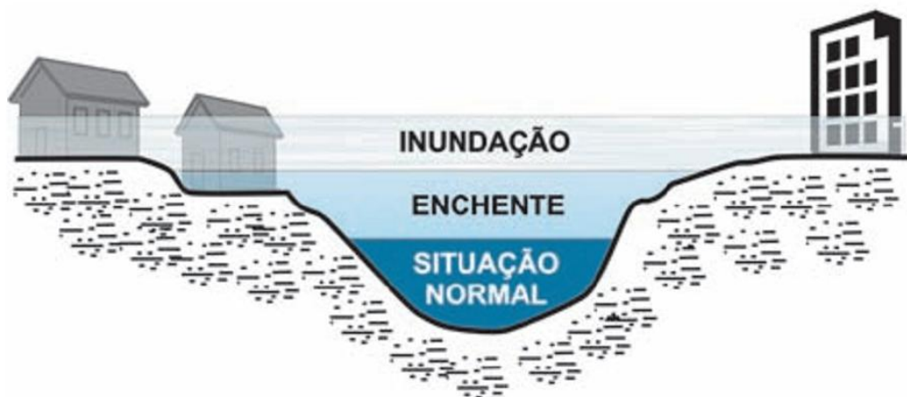
FIGURA 8: Perfil de processo de enchente e inundação.
